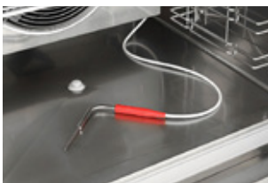
Sonda de controle no coração do alimento.
