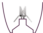
Design convencional de lâminas em formato de árvore.
